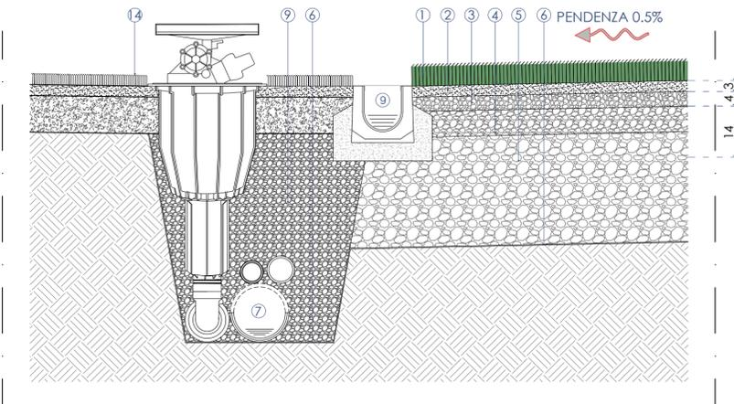
Stratigrafia tipo della pavimentazione in corrispondenza del tubo drenaggio secondario da collegare all'elemento pozzetto- scala 1:10
